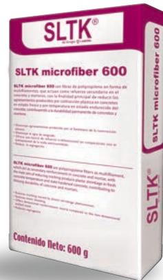
Fibras de polipropileno en forma de multifilamentos, que actúan como refuerzo secundario en el concreto y morteros, con la finalidad principal de reducir los agrietamientos producidos por contracción plástica en concretos en estado fresco y por temperatura en estado endurecido del concreto, contribuyendo a la durabilidad permanente de concretos y morteros.
