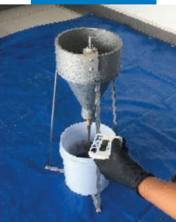
Prueba de fluidez en cono (ASTM C939)
